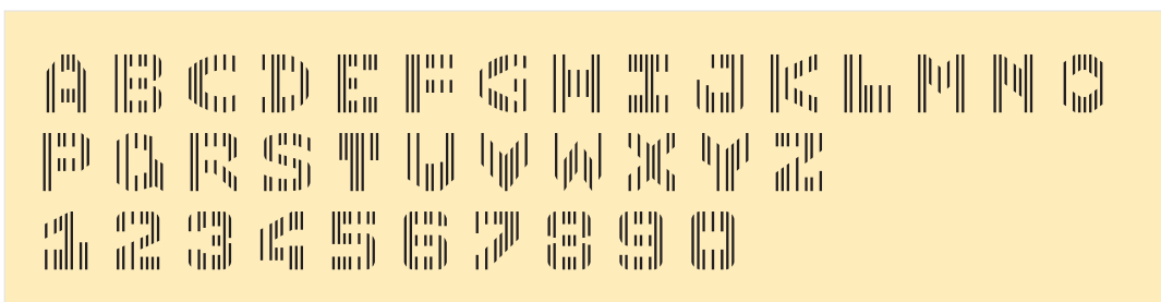
Figura 11 Carattere magnetico CMC 7 (Caractère magnétique Code à 7 bâtonnets, bâtonnets = bastoncini)
